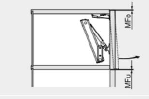
MFu Min зазор снизу 1.5 мм MFo Min зазор сверху, в зависимости от петли – см. каталог Blum
