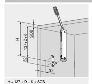
D Подъем монтажной планки (для планок без подъема D=0)
