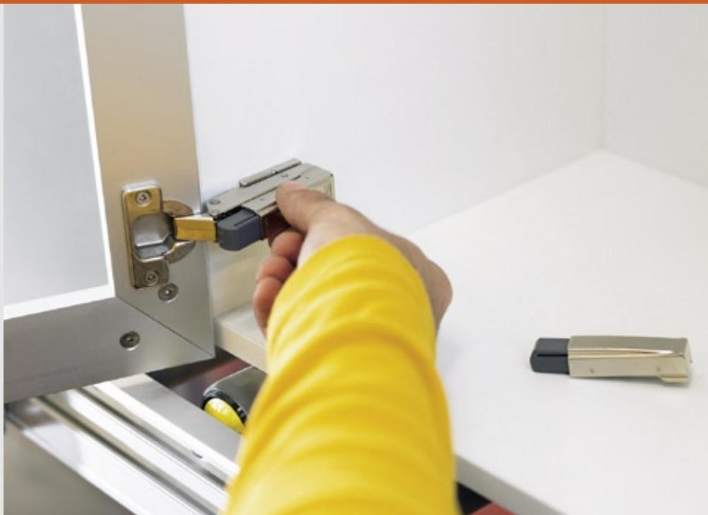
**Производство:** Лучше всего комплектовать двери системой BLUMOTION 973A уже при производстве мебели. Монтаж производится в один прием простым защелкиванием на петле CLIP top или CLIP.
