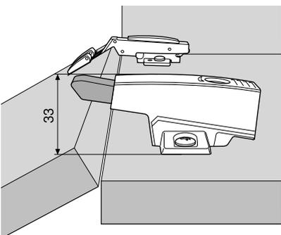
Для всех петель с прямым плечом и ответной планкой с подъемом 3 мм. Также для петель для профильных дверей 95° с ответной планкой с подъемом 0 мм.
