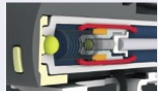
**Высокая скорость закрывания:** Регулирующий элемент расширяется, и жидкость медленно перетекает по суженным проточным каналам. В результате сопротивление в BLUMOTION возрастает.
