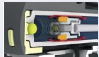
**Слишком высокая скорость закрывания:** Срабатывает предохранитель от перегрузок. Чрезмерное давление отводится через дополнительный проточный канал, защищая от повреждений BLUMOTION и петли.
