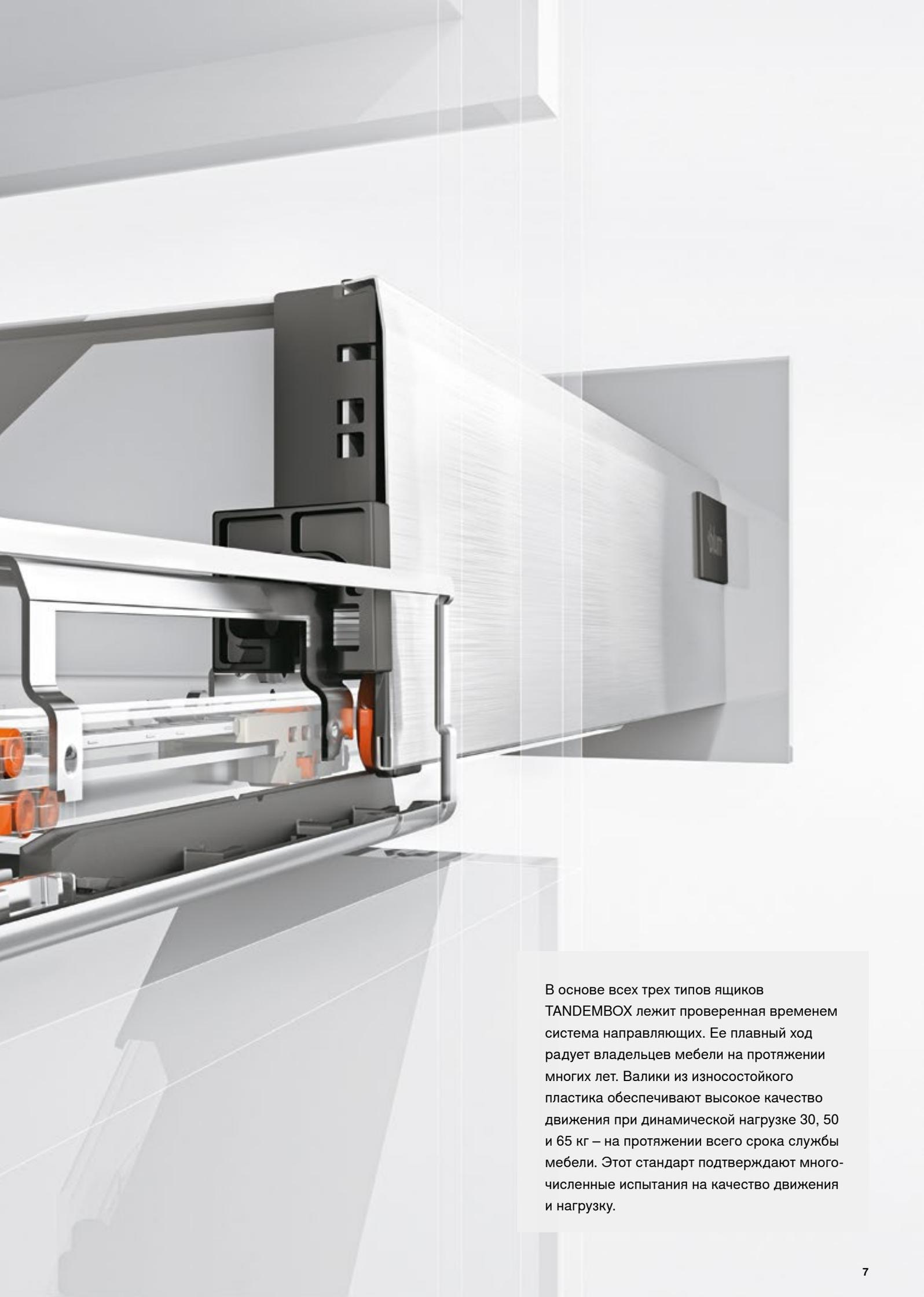
В основе всех трех типов ящиков TANDEMBOX лежит проверенная временем система направляющих. Ее плавный ход радует владельцев мебели на протяжении многих лет. Валики из износостойкого пластика обеспечивают высокое качество движения при динамической нагрузке 30, 50 и 65 кг – на протяжении всего срока службы мебели. Этот стандарт подтверждают многочисленные испытания на качество движения и нагрузку.
